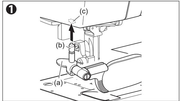
2. Déplacez la loupe pour ajuster sa position et faciliter la vision autour de l'aiguille.
