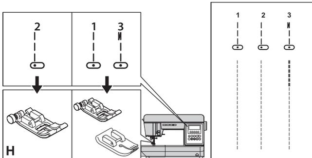
La position de l'aiguille peut être modifiée en réglant la largeur du point. (Voir page 18)
