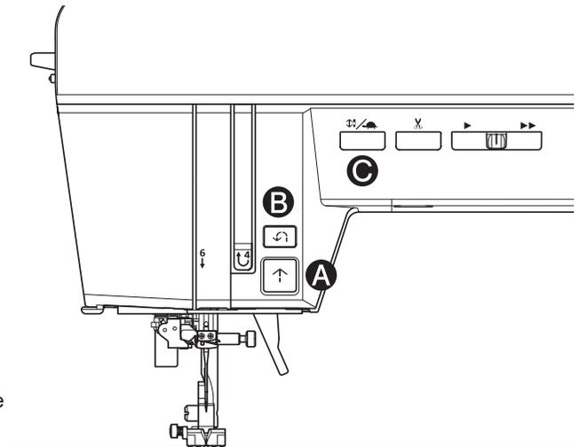
Si le fil supérieur n'est pas enfilé, la machine s'arrête après quelques tours. (Capteur de fil supérieur)
