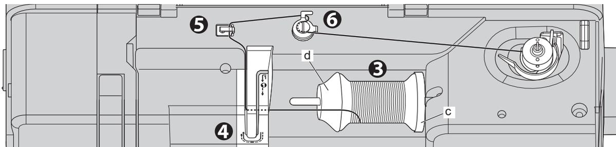
7. Tenez le fil par la main gauche et enroulez le fil sur la canette 4 à 5 fois dans le sens des aiguilles d'une montre.
