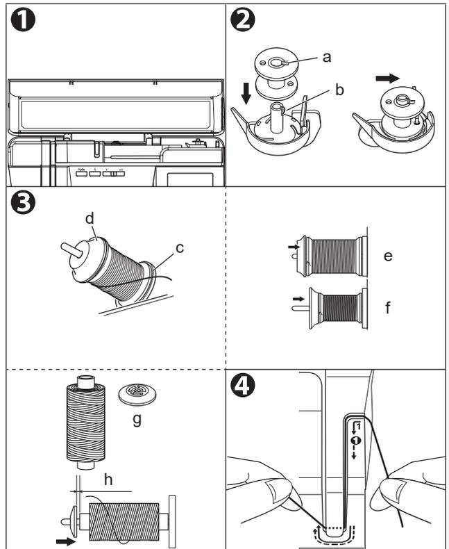
5. Amener le fil vers l'arrière et le faire passer à travers le guide d'enfilage (i) de gauche à droite.
