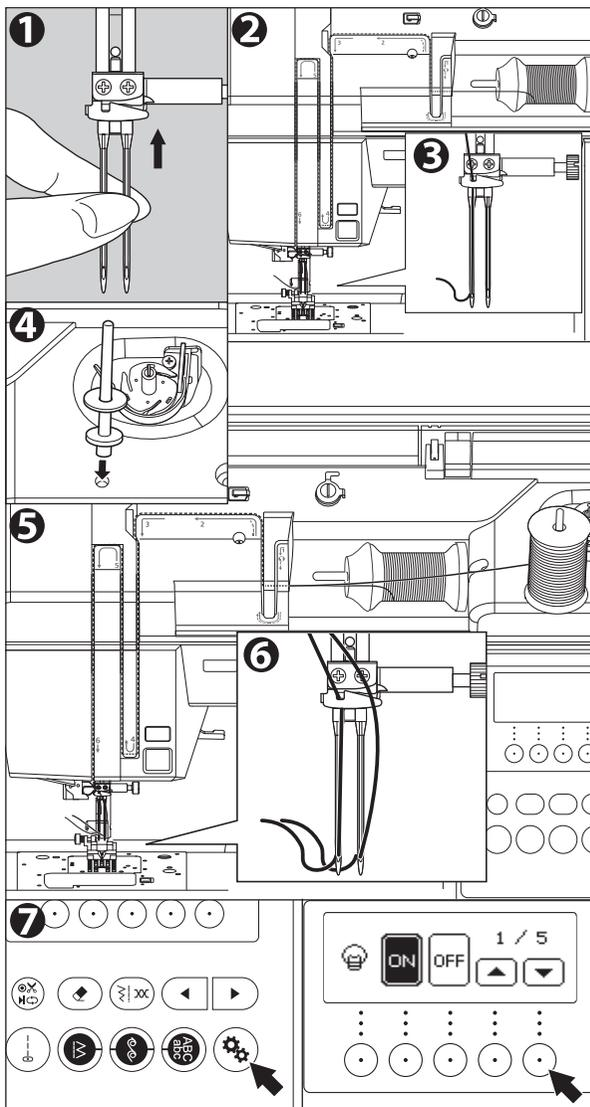
1. Retirez l'aiguille simple et insérez l'aiguille double.
