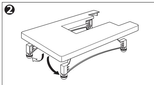
3. Insérer la table large dans la machine en la faisant glisser vers la droite.
