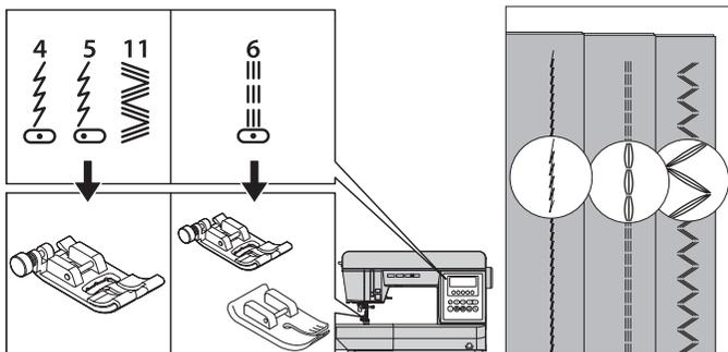
Nous vous recommandons d'utiliser une aiguille pour tricot et tissus synthétiques afin d'éviter les sauts de point et les ruptures de fils.
