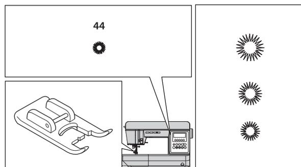
1. Placez le tissu sous le pied-de-biche et abaissez-le. Démarrez la machine. La machine coudra l'œillet et s'arrêtera automatiquement.
