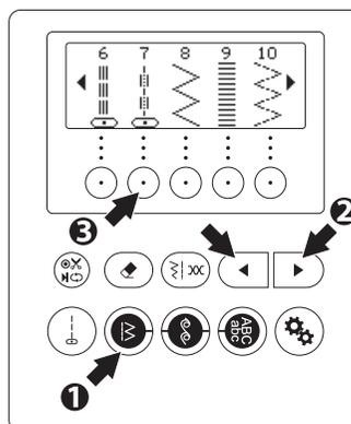
2. En touchant les boutons de sélection des points (◀ ou ▶), 5 motifs changeront de façon incrémentielle ou décrémenteille.
