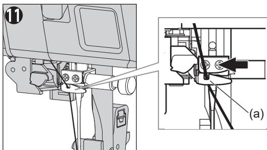
12. Passez à travers le chas de l'aiguille de l'avant vers l'arrière. Voir la section suivante pour les instructions sur l'utilisation de l'Enfileur d'aiguille.
