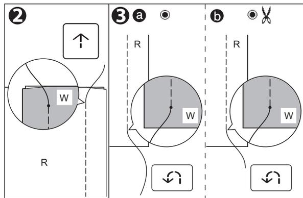
Les points utilitaires n° 3, 33-45 comprennent le point inversé ou le point d'arrêt. Dans ce cas, le bouton Point d'arrêt / Coupe sera réglé sur coupe automatique uniquement. Voir pages 43, 54-58, 64.
