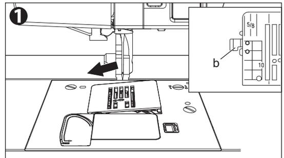
2. Poussez vers le bas le côté droit de la plaque d'aiguille de point droit qui a flotté vers le haut pour l'ajuster.
