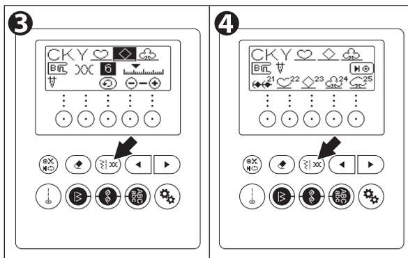
4. Effleurer à nouveau le bouton largeur/longueur/ tension pour revenir au mode sélectionner.
