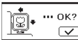
Relever l'aiguille et appuyer sur le bouton «OK».
