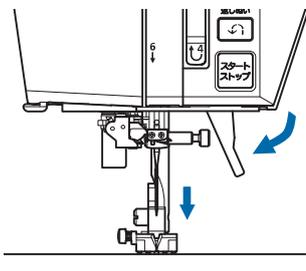
**3** 針を左手で持ちながら、付属のドライバーで針止めネジをゆるめます。
