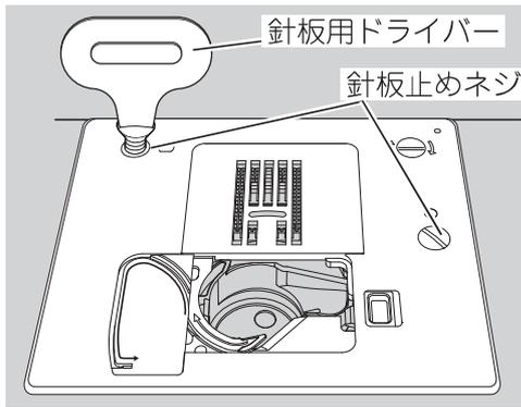
④ 針板の右側を持ち上げて、針板を取り外します。
