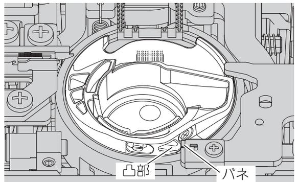
⑧ 針板左側のツメをミシン本体に差し込み、針板のピン穴をミシンのピン（手順6の図参照）に合わせて取り付けます。
