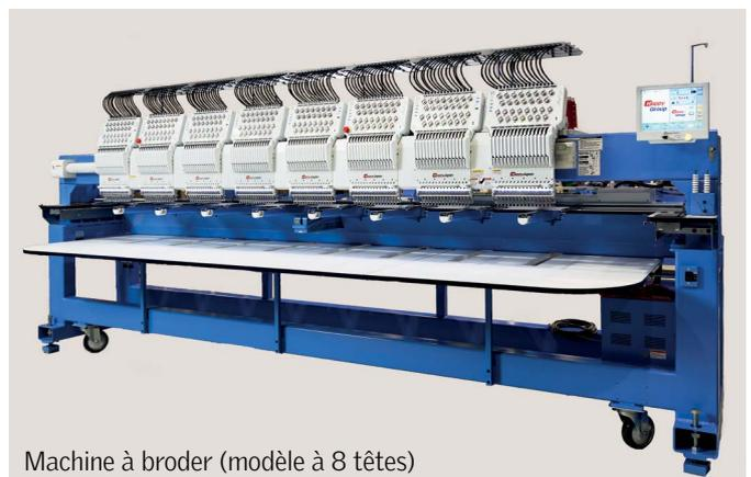
Machine à broder (modèle à 8 têtes)
