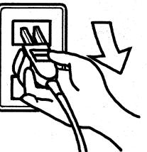
スイッチ「切」を確かめてから、電源プラグを抜き差しする
